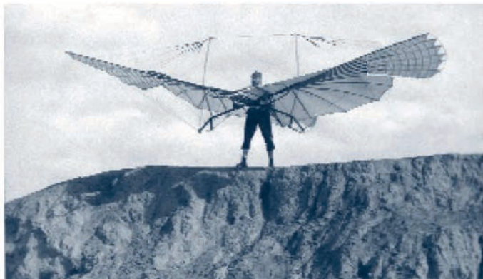
Lilienthal mit dem »kleinen Schlagflügelapparat« auf dem künstlich aufgeschütteten Fliegeberg, 1894
