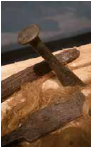
Kalfateisen zum Abdichten von Schiffsrümpfen.
