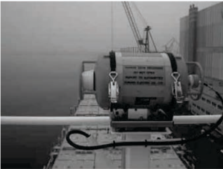
Black Box eines Voyage Data Recorders
