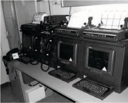
Funkpult einer GMDSS-Anlage
