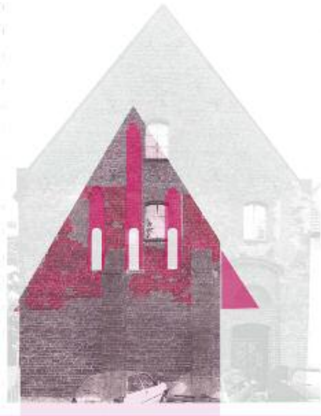
Abb. 12a/b: Neubrandenburg. Westgiebel des Nordflügels, Alterskartierung und Rekonstruktion des ältesten Zustandes, 2010 (Zeichnung: Jens Christian Holst; Vorlage: Meßbildstelle GmbH, Dresden).
